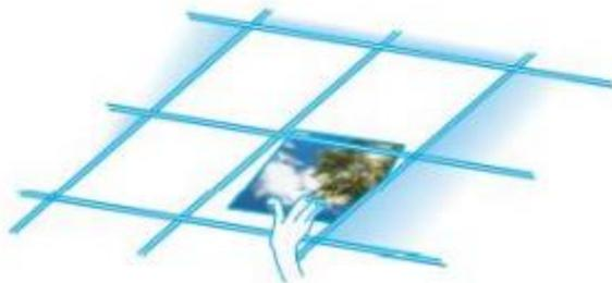
Voir mise en page pour le bon placement. Les flèches directionnelles et les chiffres sont placés à l'arrière du panneau et sur la mise en page. Assurez-vous de ne pas toucher le panneau de commande sur l'image et au milieu. Il suffit de toucher le cadre en aluminium pour empêcher les empreintes digitales et les orifices de lumière.
