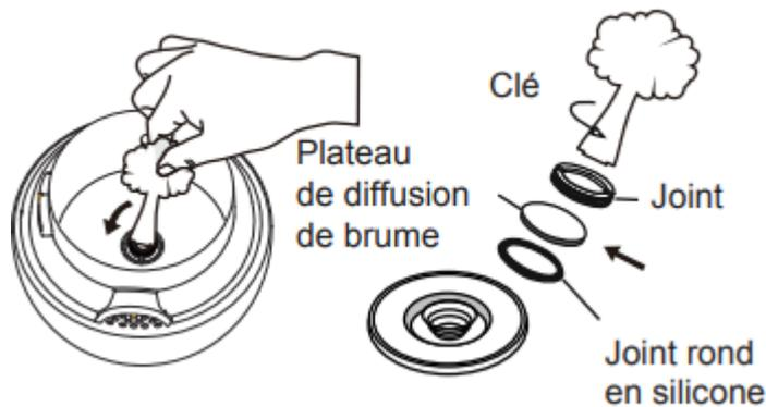
Suivez le diagramme, retirez le Plateau de diffusion de brume original en retirant le Joint à l'aide de la Clé fournie. Placez un nouveau Plateau de diffusion de brume et appuyez fermement sur le joint rond en silicone. Revissez le Joint avec la Clé pour fixer
