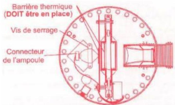
Resserrez les vis de serrage, en veillant à ne pas trop serrer. Poussez doucement le connecteur sur les plots de l'ampoule, et puis reconnectez les deux moitiés, en alignant les six vis (E). Fixez à nouveau l'objectif. Reconnectez la partie circulaire (C) et la base (D). Ne pas mélanger les vis de serrage de l'ampoule et les vis de fixation de la caisse circulaire (les vis de serrage de l'ampoule sont plus courtes).
